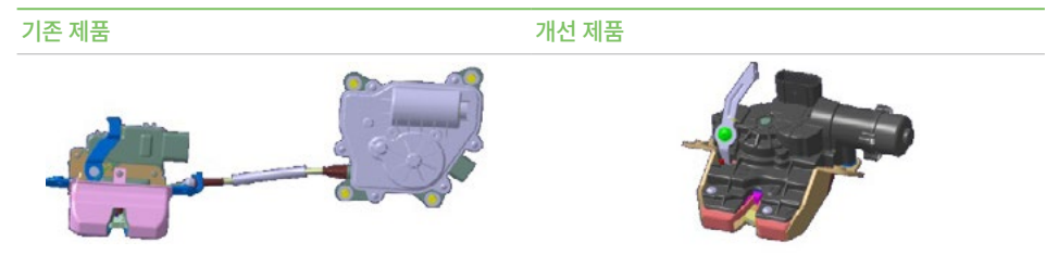
부품 통합 예시 : Power Tailgate Latch
